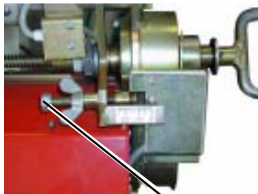
Регулировочный винт для изменения нормы высева
